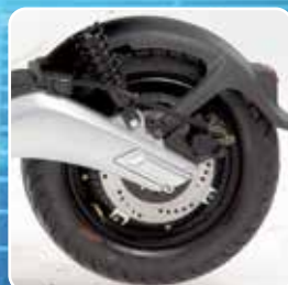
Suspension réglable 3 positions
