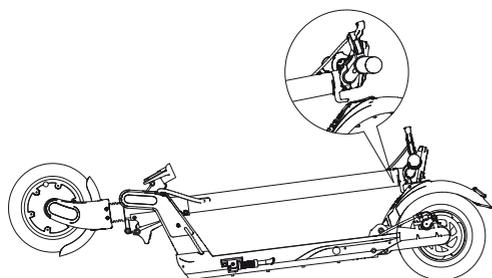
1. Pressez le garde-boue arrière pour déverrouiller
