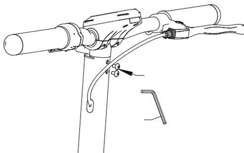
4. Après vérification du branchement, serrez les 2 vis avec la clé fournie
