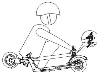
2. Lors de la fermeture, veillez à ce que le système de fermeture soit correctement verrouillé.
