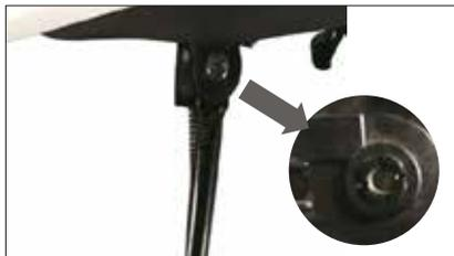
La béquille latérale est équipée d'une sécurité empêchant le démarrage du scooter.
