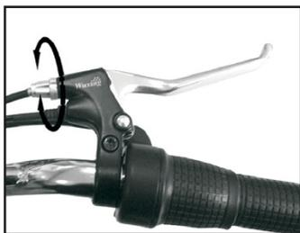
**Etape 2:** Régler à 30mm la distance entre le bras de levier du frein arrière et la gaine après avoir desserré le câble avec un clé de 10mm.
