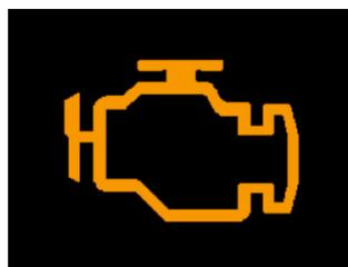
La fréquence de clignotement de ce témoin de défaut est structurée de façon à identifier le composant mis en cause dans le dysfonctionnement.
