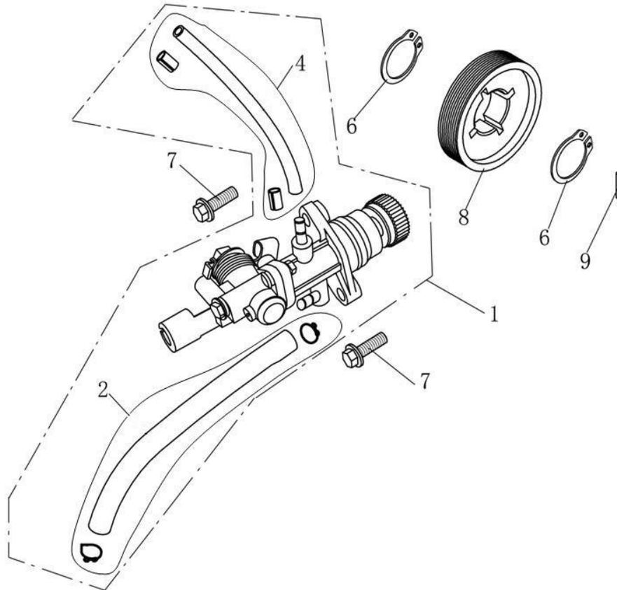
**E-6 机油泵分总成 OIL PUMP ASSY.**
