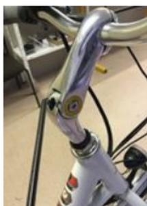
Mettre la potence en position horizontale pour accéder à la vis BTR (clé Allen de 6mm).
