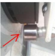
Vérifier que le galet de la contre-poulie fixée sur la patte de cadre, à côté de la roue libre soit à une distance de 0.5 mm maxi de la courroie pour éviter tout saut de dent.
