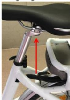
Dévisser la vis BTR (clé Allen de 6mm) situé sous le chariot de selle, puis régler l'inclinaison et l'avance ou le recul du chariot de selle.
