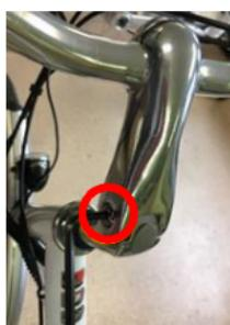
L'orientation se fait à l'aide d'une clé Allen de 5mm.
